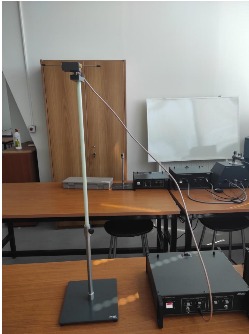
Εικόνα 4.4 Κεραία Διπόλου με γεννήτρια συχνοτήτων στα 1 GHz
