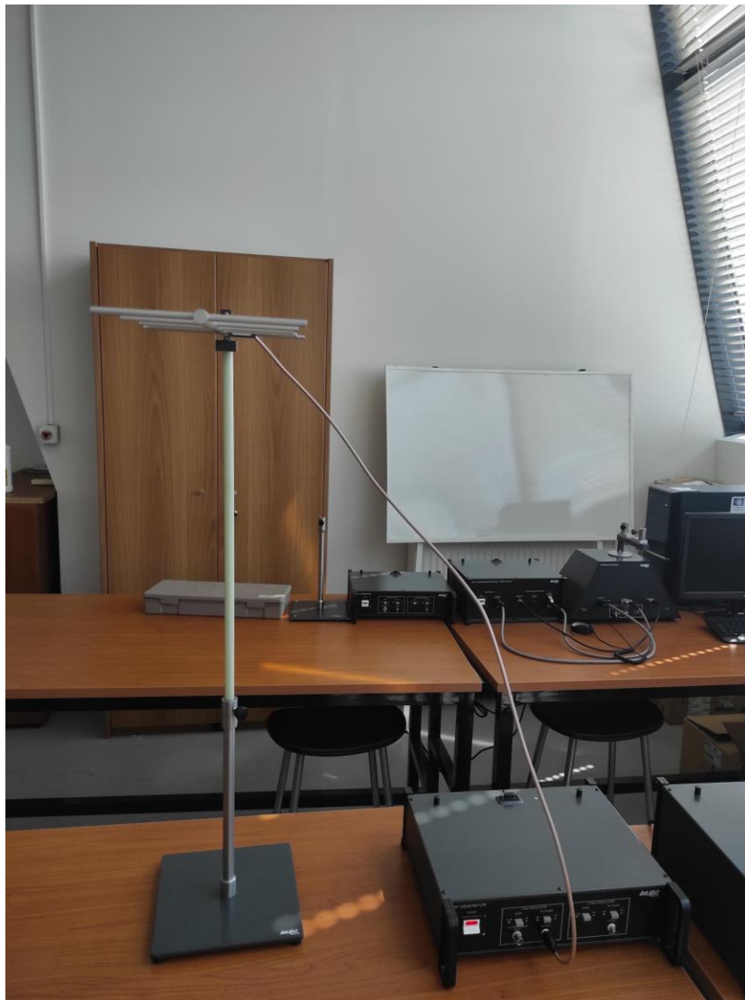
Εικόνα 4.3 Yagi Uda με γεννήτρια συχνοτήτων στα 1 GHz
