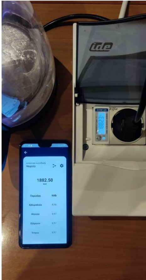
Εικόνα 78: Πείραμα μέτρησης κατανάλωσης βραστήρα
