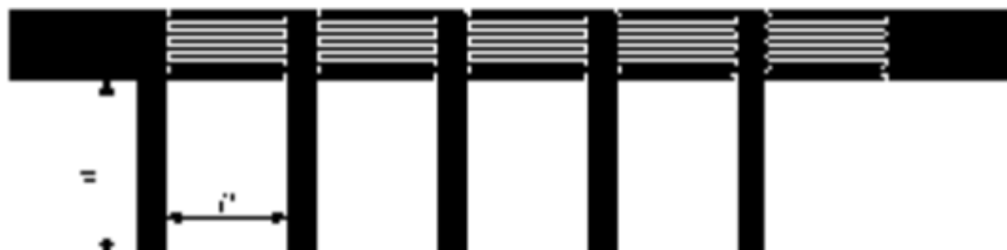
Εικόνα 10. Γραμμή μεταφοράς κατασκευασμένη από 5 δομικές μονάδες μεταλλικού (Liu & Huang, 2010).
