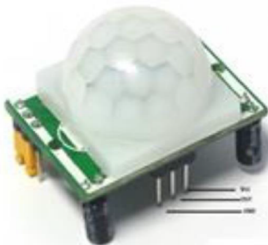
Εικόνα 19. Αισθητήρας PIR (Krishna et al., 2017)
