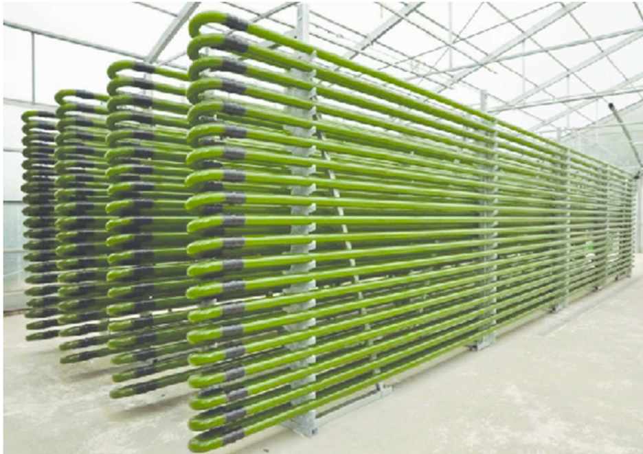
Σχήμα 2.4. Διάταξη σωληνοειδούς/αυλωτού φωτό-βιοαντιδραστήρα.
