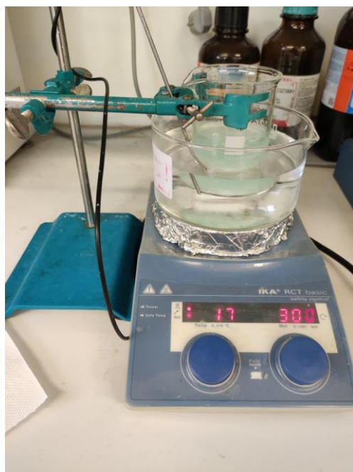
Εικόνα 3.1. Θέρμανση και ανάδευση με σκοπό την εξάτμιση του νερού.
