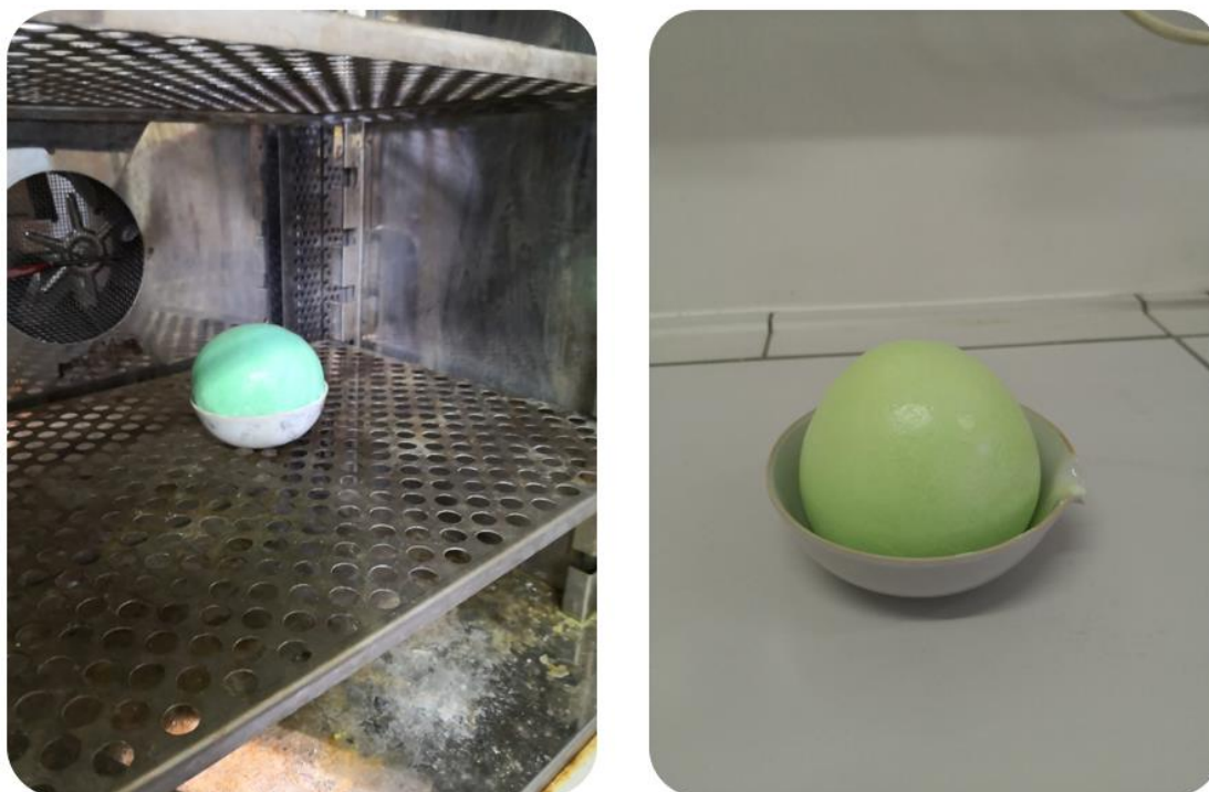
Εικόνα 4.1. Σφαιρική κιτρική ξηρογέλη μετά από ξήρανση στους 120°C.
