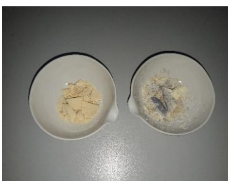
Εικόνα 3.2.5: Μετά την ξήρανση στους 90\text{ }^\circ\text{C} για 12 h στα αριστερά και μετά την πύρωση στους 500\text{ }^\circ\text{C} για 2 h (ρυθμός ανόδου θερμοκρασίας 5\text{ }^\circ\text{C}/\text{min} ) στα δεξιά
