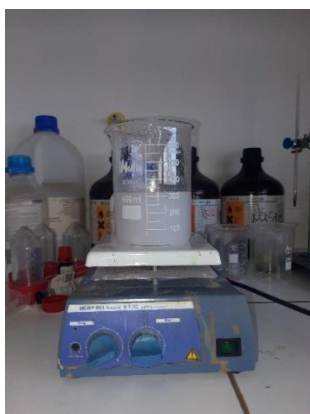
Εικόνα 3.2.1: Ανάμιξη των υδατικών διαλυμάτων \text{NaOH} και \text{Ce}(\text{NO}_3)_3 \cdot 6\text{H}_2\text{O}
