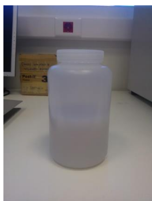
Εικόνα 3.2.2: Μεταφορά διαλύματος σε δοχείο από Teflon προς ξήρανση για 24 h
