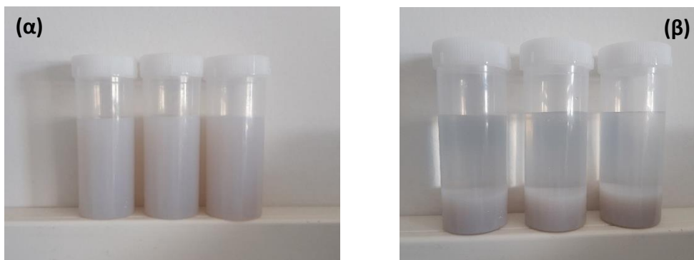
Εικόνα 3.2.4: (α) Προσθήκη δις απιονισμένου H_2O σε κάθε μπουκαλάκι και ανακάτεμα με τη γυάλινη ράβδο πριν από κάθε φυγοκέντριση. (β) Διάλυμα μετά τη φυγοκέντριση.
