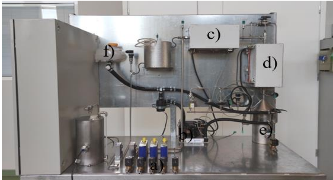
Εικόνα 3.5: α) Οι βαλβίδες και τα Mass Flows, β) Το ρεύμα που αναμιγνύονται τα αντιδρώντα, γ) ο φούρνος όπου θερμαίνεται το ρεύμα, δ) Ο αντιδραστήρας, ε) Ο εναλλάκτης θερμότητας και ς) το δοχείο τροφοδοσίας του ψυκτικού νερού.
