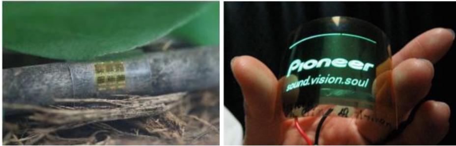
Σχήμα 2.20: Φωτοβολταϊκό πάνελ τυλιγμένο σε ένα κλαδί δέντρου διαμέτρου 3 mm (αριστερά) και εύκαμπτη οθόνη από νανοκυτταρίνη (δεξιά).
