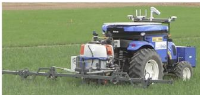
Εικόνα 6: Εφαρμογή ζιζανιοκτόνου με χρήση έξυπνου ψεκασμού
