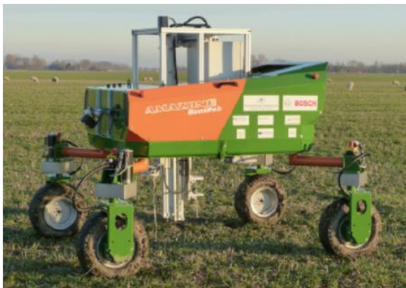
Εικόνα 5: Το Bonirob μαζί με μετρητή διεύθυνσης εδάφους
