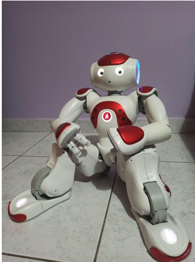
Εικόνα 3.3 - Ρομπότ NAO που χρησιμοποιήθηκε στην παρούσα εργασία
