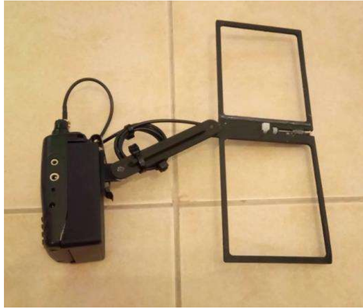
Εικόνα 21. Κατασκευή κεραίας UHF Μοxon 433 MHz
