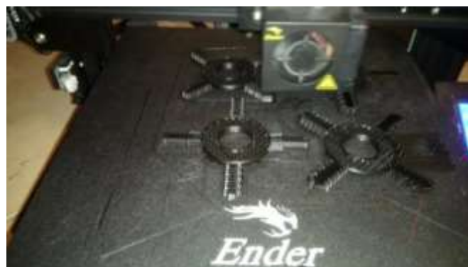
Εικόνα 18. Κατασκευή κεραίας με 3D εκτύπωση
