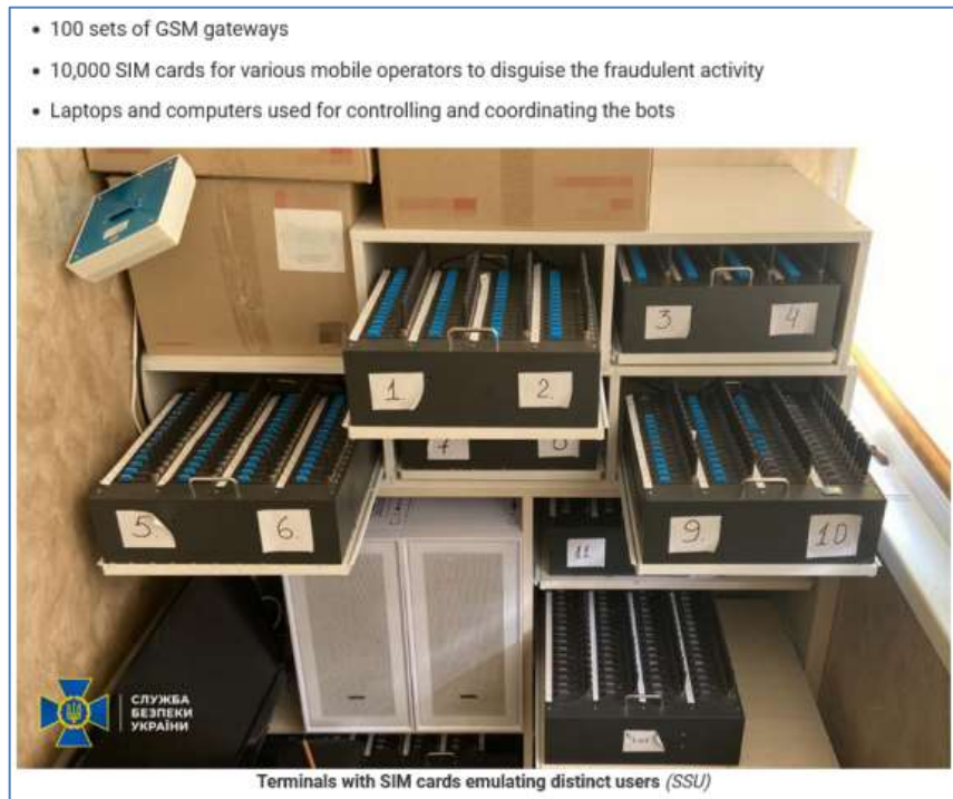
Εικόνα 54. Sim Farm υλικό που διαχειρίζεται εκατοντάδες κάρτες SIM
