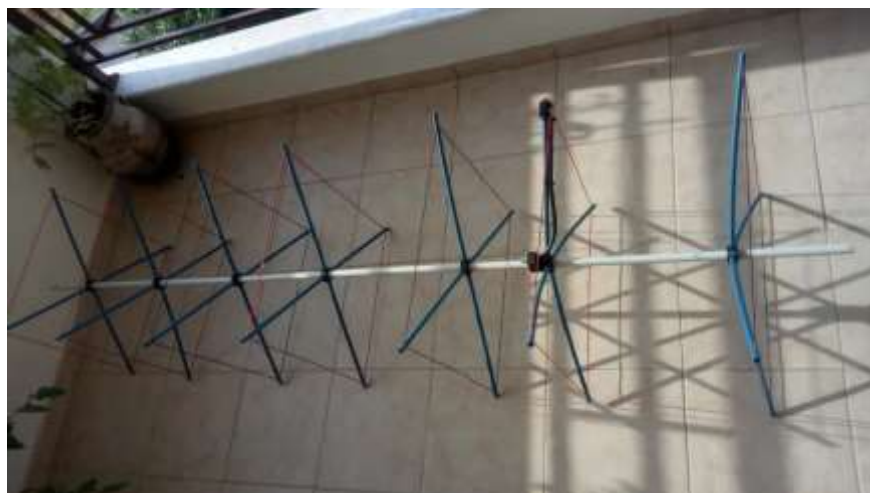
Εικόνα 20. Κατασκευή κεραίας Qubic Quad με 3D εκτύπωση
