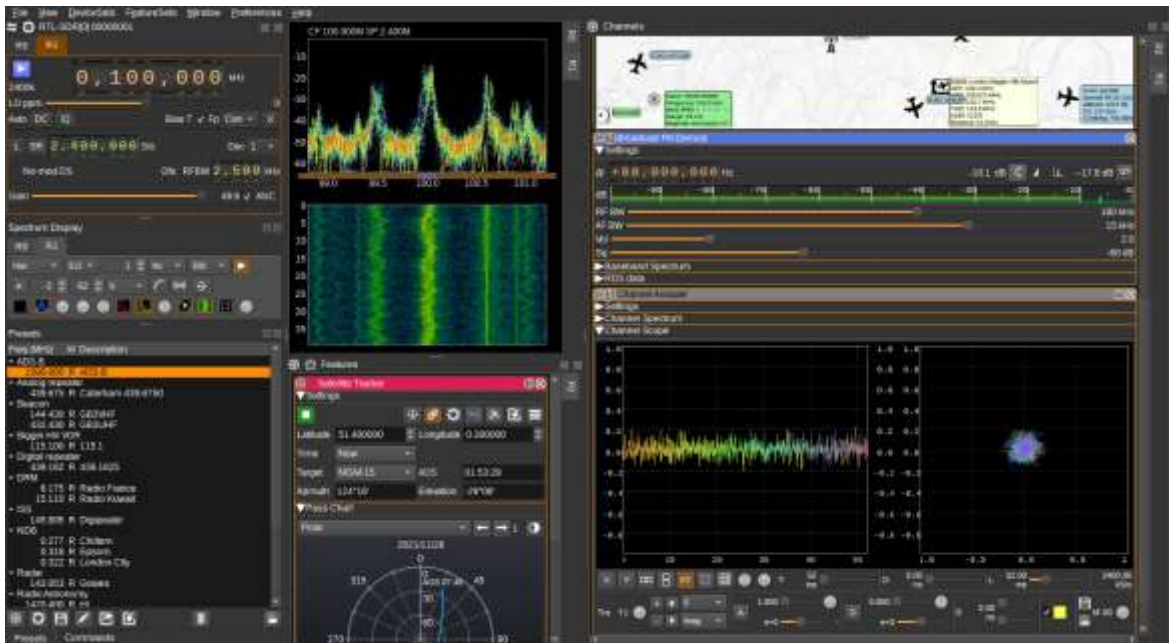
Εικόνα 36. SDRangel software με λήψη beacon της πολιτικής αεροπορίας
