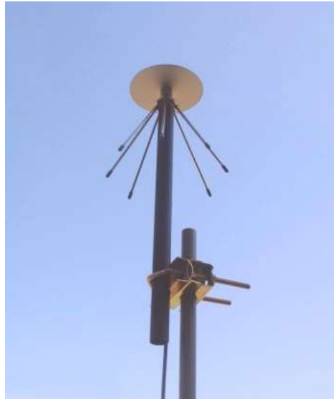
Εικόνα 17 Κεραία Discone, εύρους συχνοτήτων 400 to 4000 MHz
