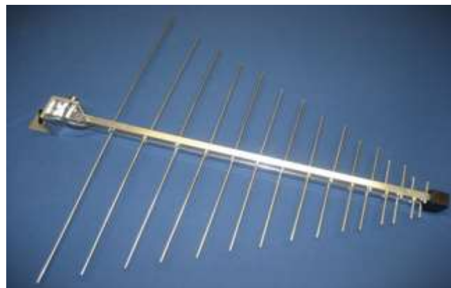
Εικόνα 16. Κεραία Logperiodic Εύρους συχνοτήτων 250-1000MHz
