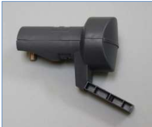
Εικόνα 13. Satellite LNB (Downconverter)
