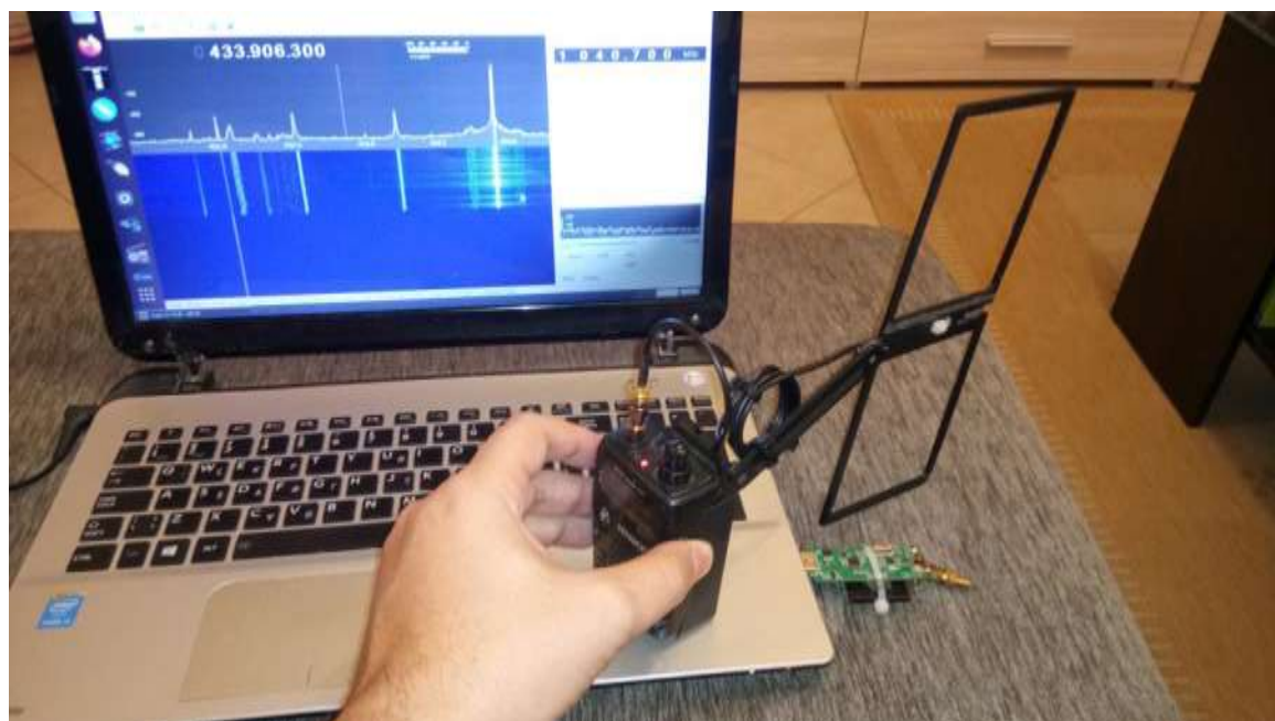
Εικόνα 32. Ρύθμιση του πομπού για εκπομπή επάνω στην συχνότητα του κλειδιού
