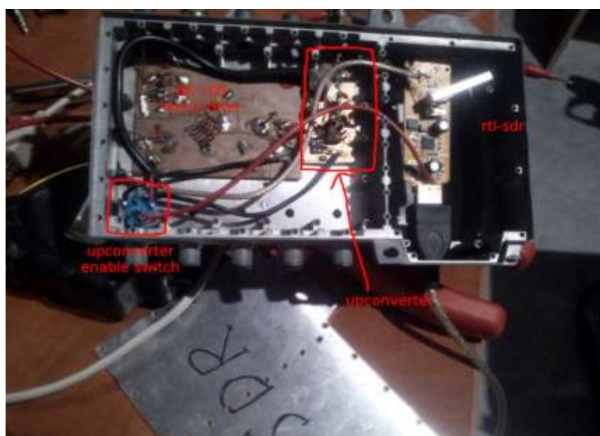
Εικόνα 12. Ιδιοκατασκευή RTL-SDR μαζί με Upconverter σε μεταλλικό κουτί
