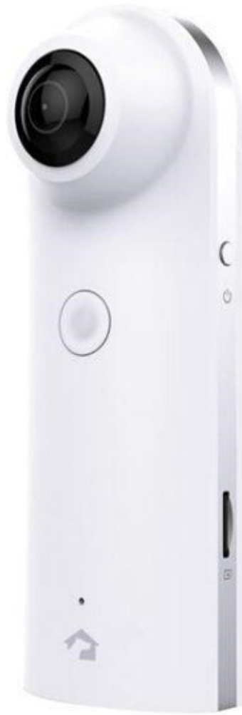
Εικόνα 5. Ψηφιακή φωτογραφική κάμερα με λήψη 360 μοιρών Unicam360
