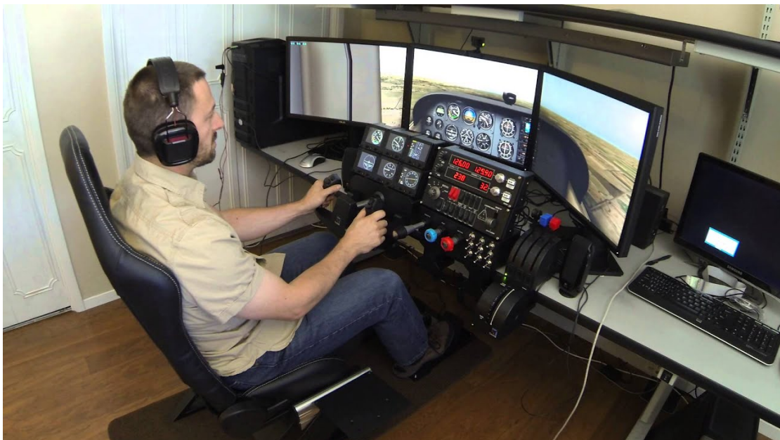
Εικόνα 10 Σύστημα προσομοίωσης πτήσης μέσης πιστότητας. Ο χρήστης διαθέτει εξοπλισμό για τον χειρισμό του εικονικού αεροσκάφους
