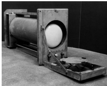
Εικόνα 103: Ο σωλήνας Williams-Kilburn (πηγή: https://www.computerhistory.org/storageengine/williams-demonstrates-crt-storage/ )
