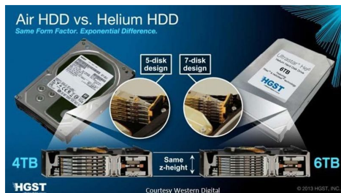
Εικόνα 134: Ο πρώτος δίσκος με ήλιο (πηγή: https://www.computerhistory.org/storageengine/helium-drives-cloud-storage/ )
