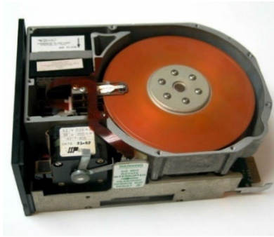
Εικόνα 122: Το εσωτερικό του σκληρού δίσκου Seagate ST-506
