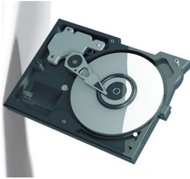
Εικόνα 126: Ο σκληρός δίσκος της IBM 0663 “Corsair” με κεφαλή AMR (1991) (πηγή: https://www.computerhistory.org/storageengine/magnetoresistive-read-head-hdd-introduced/ )
