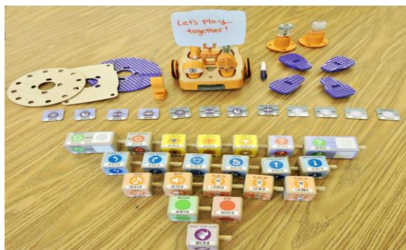
Εικόνα 1.10: Το ρομπότ KIBO και τα μπλοκ του
