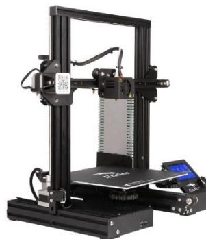
Εικόνα 2.23: Ο τρισδιάστατος εκτυπωτής Ender-3
