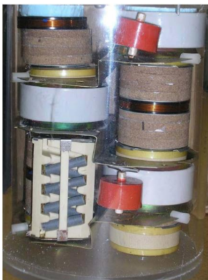
Σχήμα 18: Εσωτερικό εκτροπέα υπέρτασης SiC με διάκενα [20].
