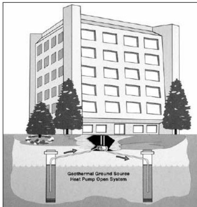
Σχήμα 1.2: Γεωθερμικό κύκλωμα απορρόφησης-αποβολής [3]
