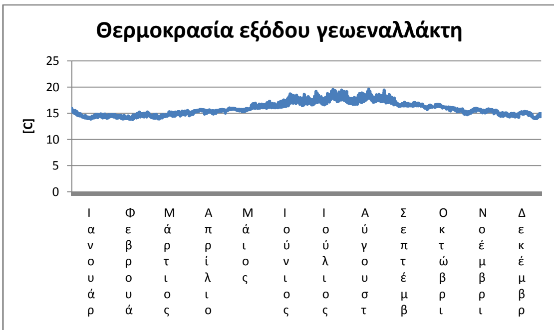
Σχήμα 6.10: Θερμοκρασία εξόδου γεωεναλλάκτη
