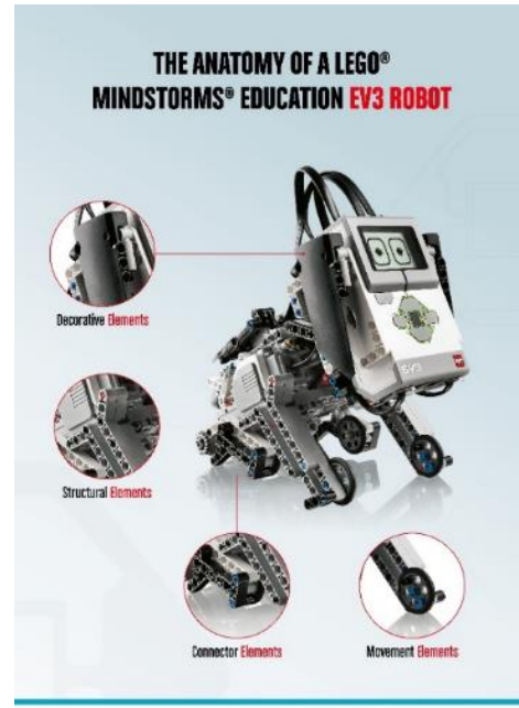
Εικόνα 14: Η ανατομία του EV3 robot
