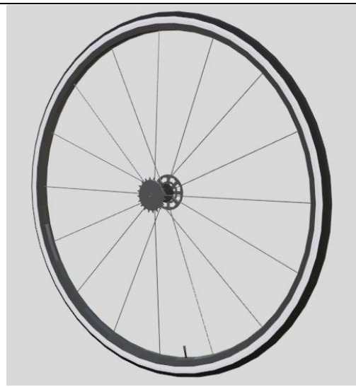
Εικόνα 22: Πίσω τροχός (μαζί με ελεύθερο γρανάζι και δισκόφρενο)
