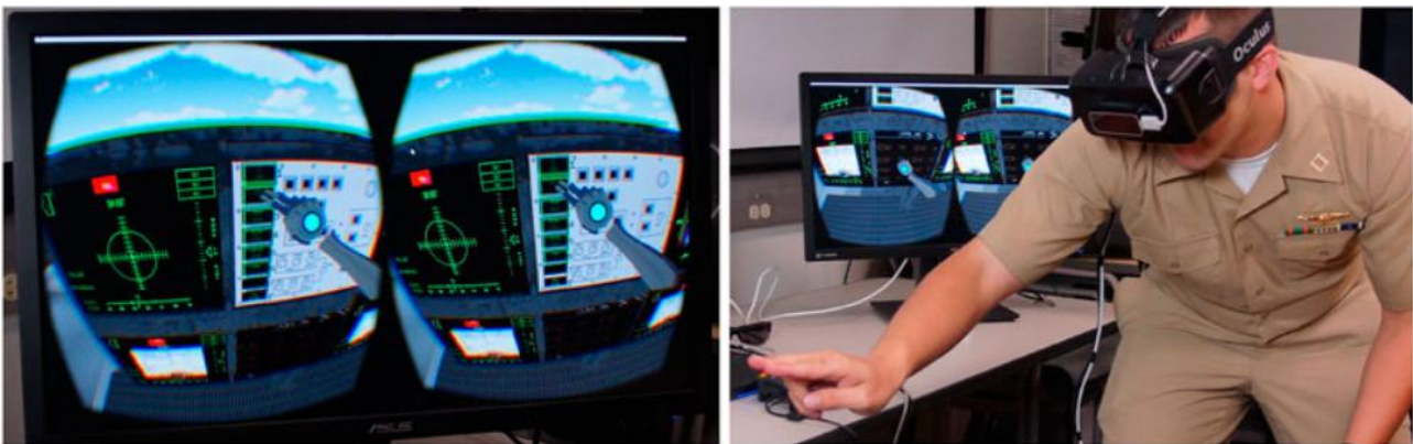
Εικόνα 3: Επίδειξη του συστήματος εκπαίδευσης αεροπορίας Landing Signal Officer Display System [16]
