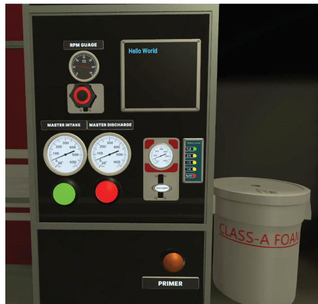
Εικόνα 1: Πίνακας ελέγχου πυροσβεστικού οχήματος σε ΕΠ [8]
