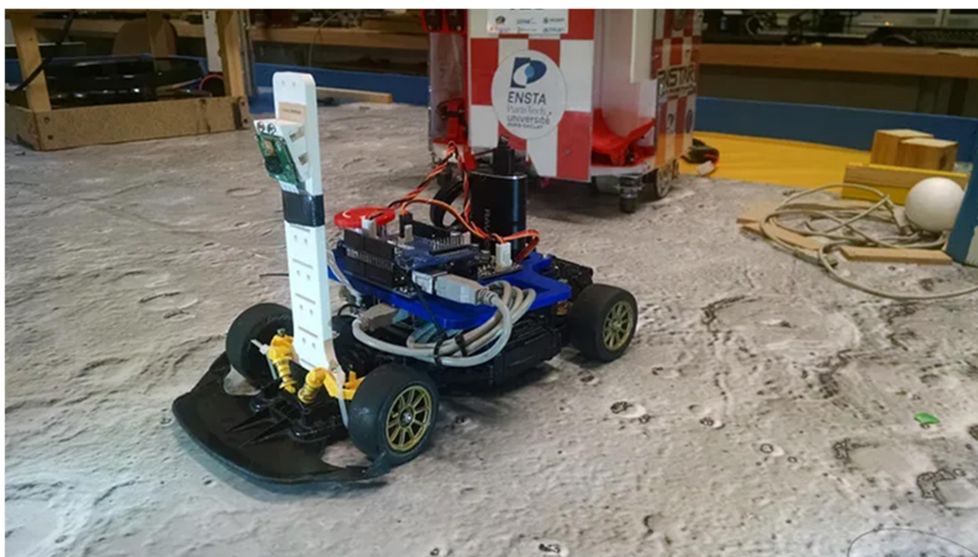
Εικόνα 31. Αυτόνομο όχημα με αισθητήρες και κάμερα
