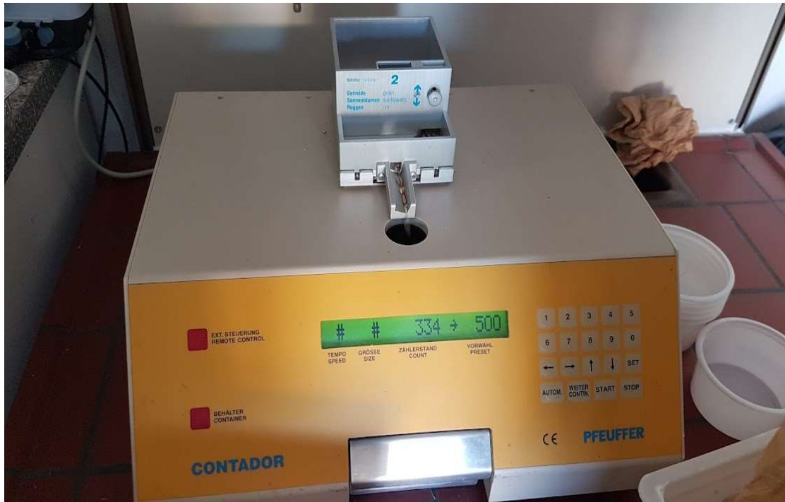
Εικόνα 11: Συσκευή Contador του Γερμανικού Οίκου Pfeuffer για ακριβή μέτρηση 1000 κόκκων σιτηρών διαστάσεων από 0,3 έως 15 χιλ.
