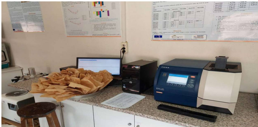
Εικόνα 10: Όργανο Infratec™ 1241 GrainAnalyzerFOSS για μέτρηση περιεκτικότητας πρωτεΐνης και υγρασίας κατάλληλο για μικρές ποσότητες δείγματος.
