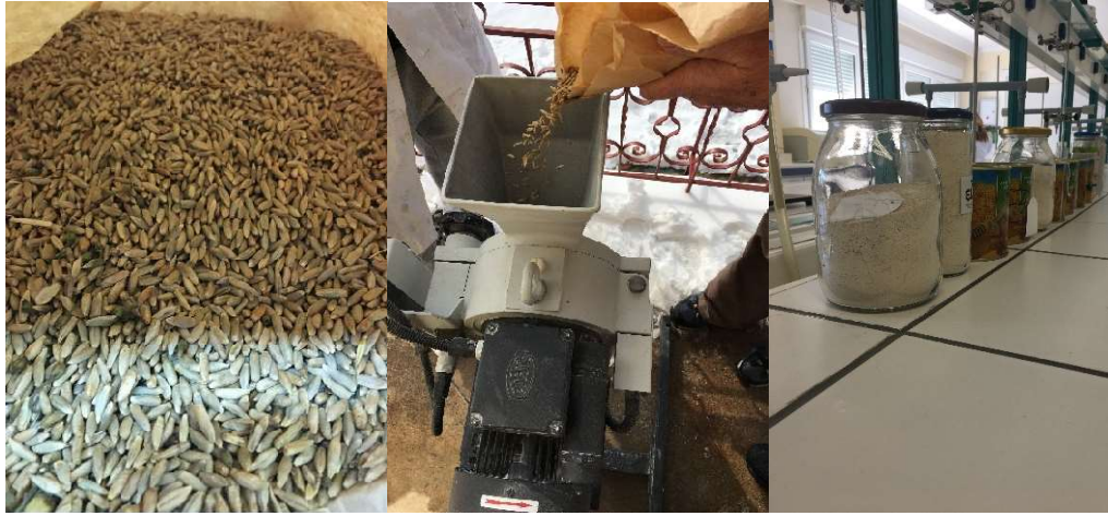
Εικόνες 3.6, 3.7 και 3.8: Σπόροι προς άλεση (αριστερά). Εργαστηριακός μύλος άλεσης (μέση). Δείγματα αλεύρου μέσα σε επισημασμένα δοχεία (δεξιά). (Πηγή: Προσωπικό αρχείο-Νιτσάϊ Ναούμ).
