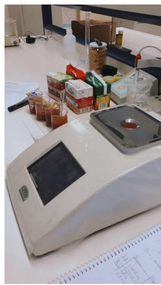
Εικόνα 9: Προσδιορισμός Brix και δείκτη διάθλασης σε δείγματα εμπορίου.
