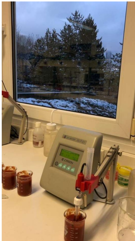
Εικόνα 8: Προσδιορισμός pH με τη βοήθεια pHάμετρου σε δείγματα τοματοπολτών.
