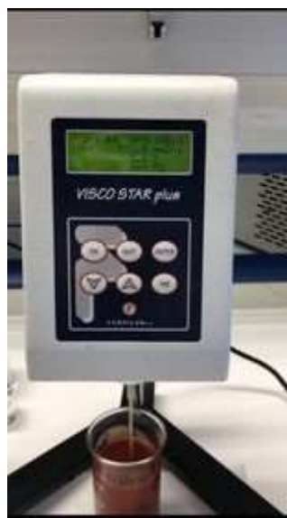
Εικόνα 11: Προσδιορισμός ιξώδους σε δείγματα τοματοπολτού του εμπορίου.
