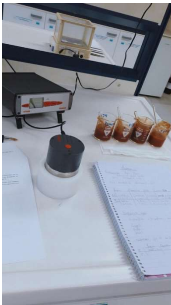
Εικόνα 10: Εύρεση ενεργότητας νερού με τη βοήθεια εργαστηριακού οργάνου.
