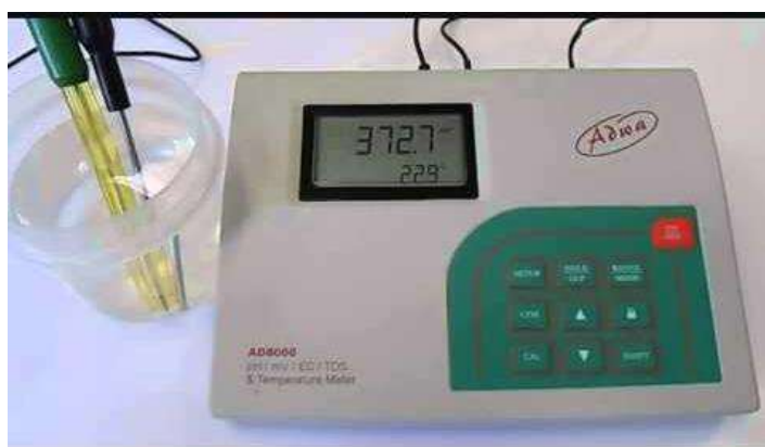
Εικόνα 9. Φωτογραφία πεχαμέτρου πάγκου. Στην εικόνα αριστερά φαίνεται το ηλεκτρόδιο το οποίο είναι εμβαπτισμένο σε άχρωμο διάλυμα.
