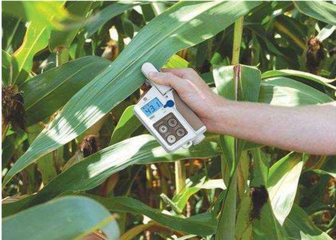
Εικόνα 15: Φορητό όργανο SPAD 52 PLUS για μέτρηση της περιεκτικότητας χλωροφύλλης.
