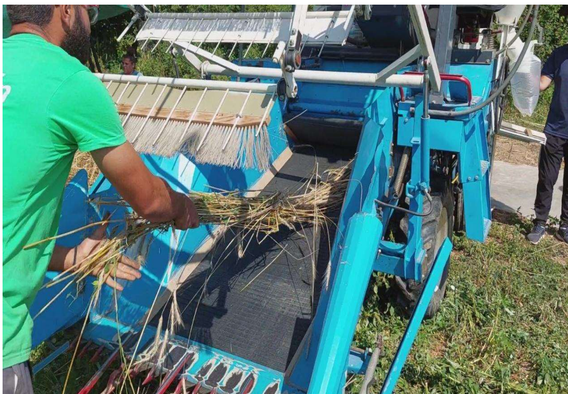
Εικόνα 11: Συγκομιδή σίκαλης με πειραματική θεριζοαλωνιστική μηχανή
