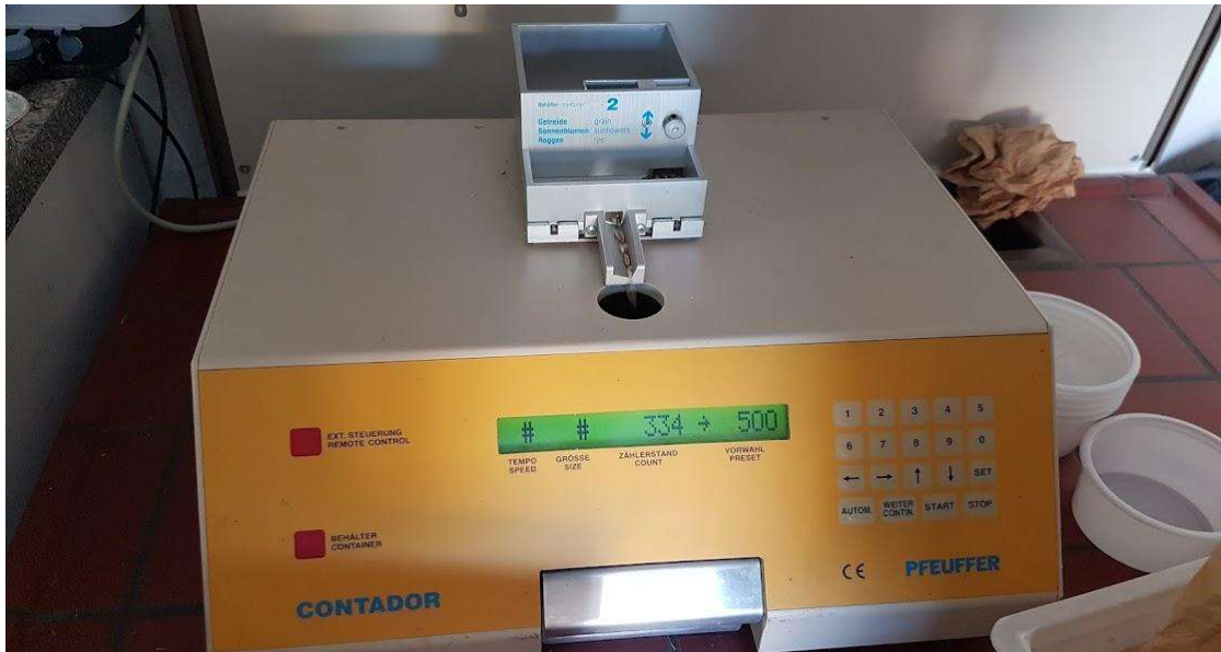
Εικόνα 16: Συσκευή Contador του Γερμανικού Οίκου Pfeuffer για ακριβή μέτρηση 1000 κόκκων σιτηρών διαστάσεων από 0,3 έως 15 χιλ.
