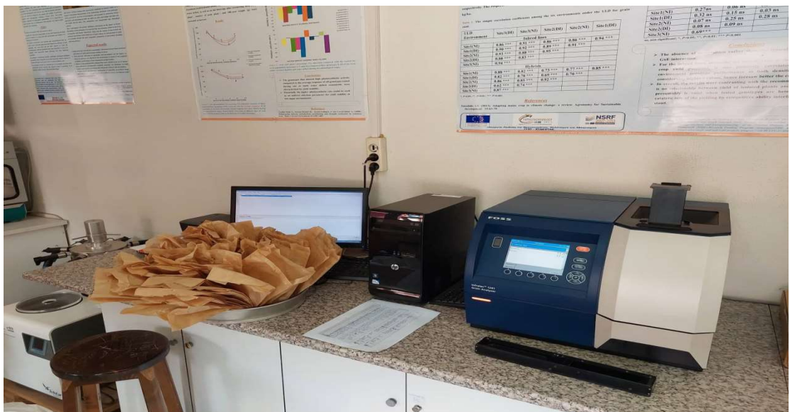
Εικόνα 17: Όργανο Infratec™ 1241 Grain Analyzer FOSS για μέτρηση περιεκτικότητας πρωτεΐνης και υγρασίας κατάλληλο για μικρές ποσότητες δείγματος.
