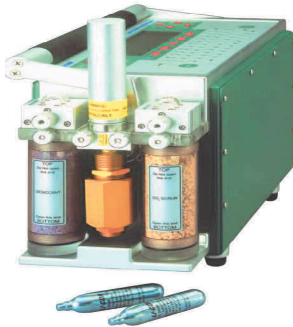
Εικόνα 11.19: Μέτρηση των παραμέτρων της φωτοσύνθεσης (Photo, Conductance, C_i & Tmmol ), δηλαδή του ρυθμού φωτοσύνθεσης, της στοματικής αγωγιμότητας, της διακυτταρικής συγκέντρωσης σε διοξείδιο του άνθρακα και του ρυθμού διαπνοής LI-6400 XT, Li-Cor
