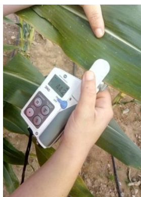
Εικόνα 8: Φορητός μετρητής χλωροφύλλης SPAD 502, Konica Minolta απορρόφησης διπλού μήκους κύματος 650 και 940nm (Φλώρινα 2020)
