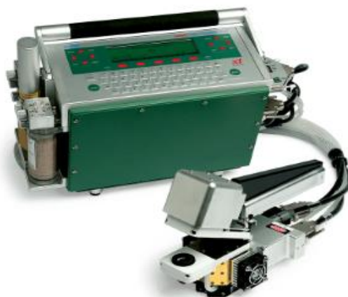
Εικόνα 9 : Φορητή συσκευή για μέτρηση φωτοσύνθεσης LI-6400XT system, της LI-COR Biosciences. Πηγή: https://www.licor.com/env/products/photosynthesis/LI-6400XT/
