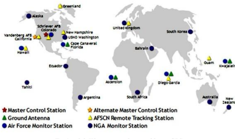
Εικόνα 2: Χάρτης του επίγειου τμήματος ελέγχου GPS
