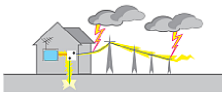
Σχήμα 19 - Άμεση κεραυνοπληξία στις γραμμές παροχής
