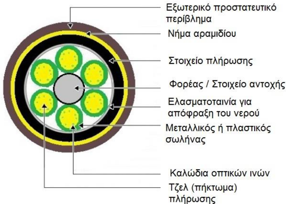
Σχήμα 4 - Διατομή καλωδίου OPAC
