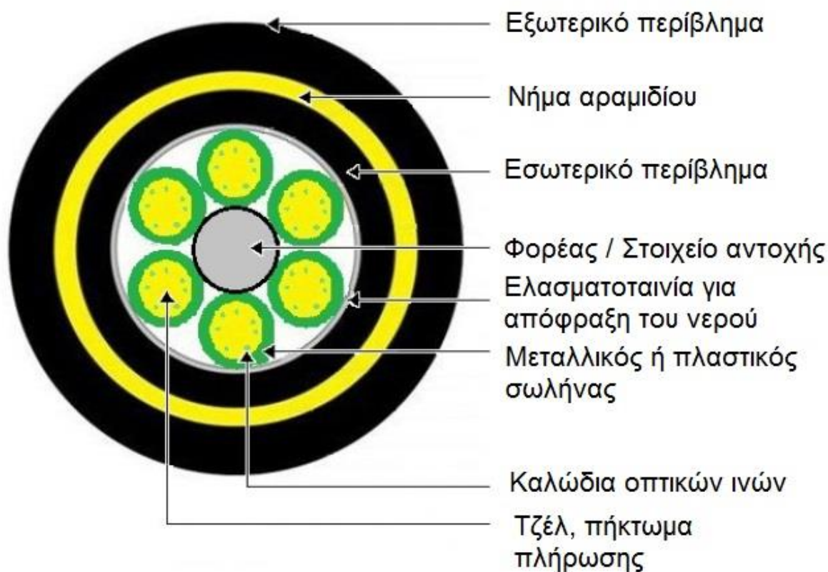
Σχήμα 3 - Διατομή καλωδίου ADSS
