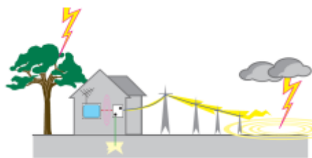
Σχήμα 19 - Άμεση κεραυνοπληξία στις γραμμές παροχής
