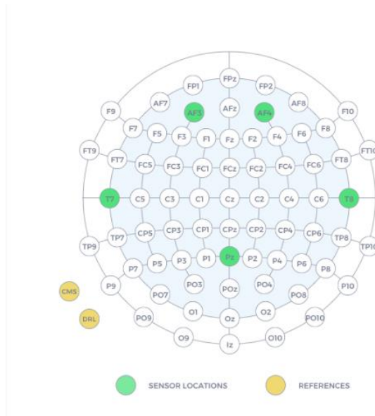
Εικόνα 16. Οι θέσεις των 5 αισθητήρων του εγκεφαλογράφου INSIGHT[40].
