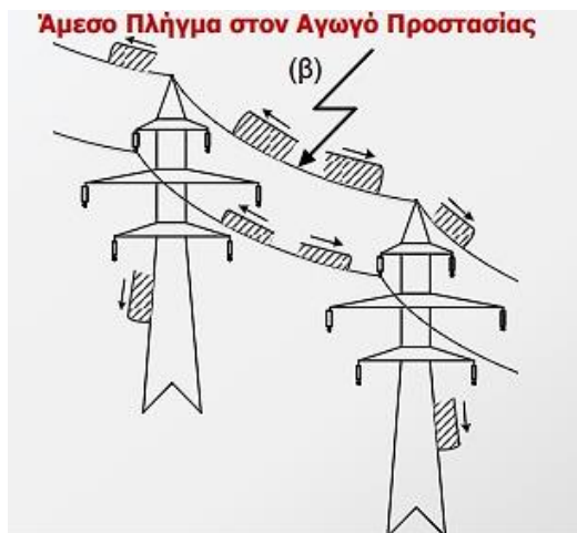
Εικόνα 2.1 Οδεύοντα και επαγόμενα κύματα λόγω άμεσου πλήγματος σε αγωγό προστασίας, περίπτωση ανάστροφης διάσπασης [8].
