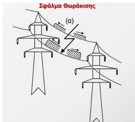
Εικόνα 2.2 Οδεύοντα κύματα λόγω άμεσου πλήγματος σε αγωγό φάσης, περίπτωση σφάλματος θωράκισης [8].
