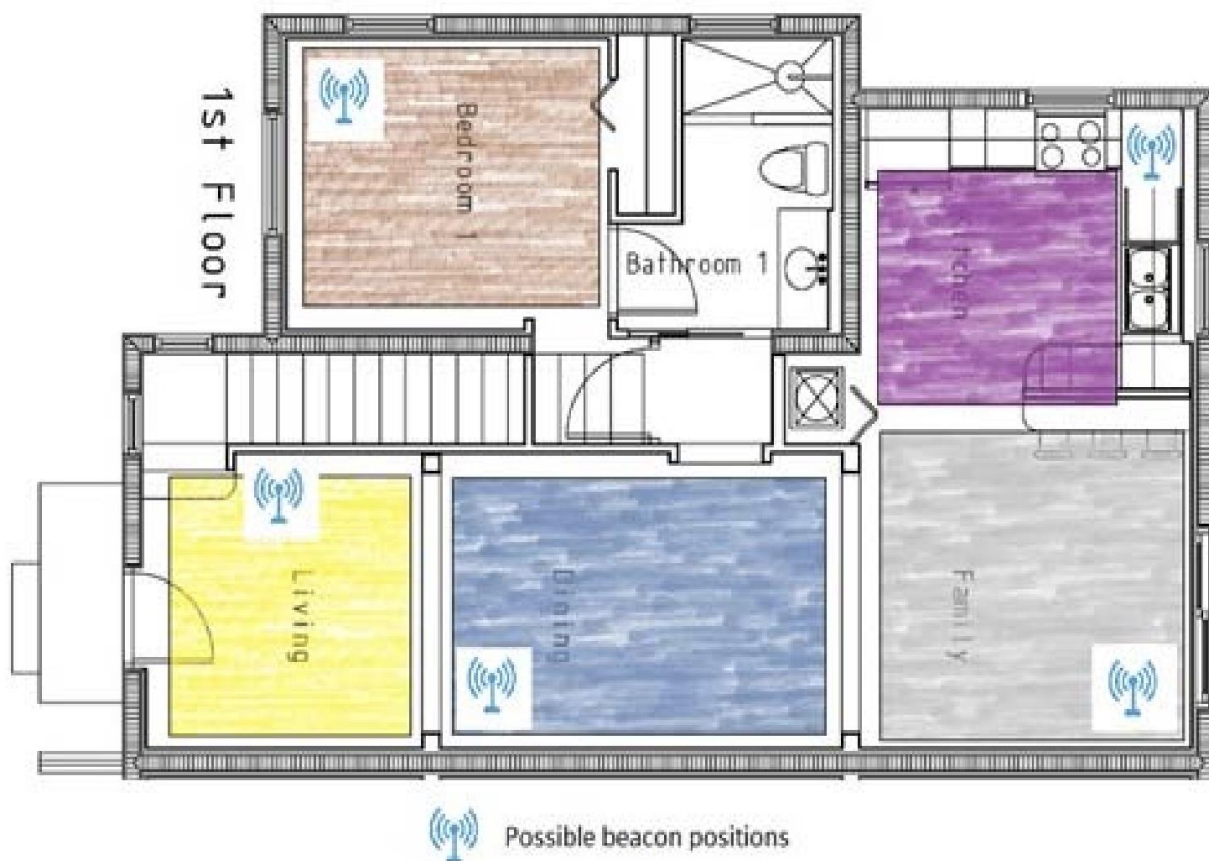
Εικόνα 2. 1 Παράδειγμα τοποθέτησης ασύρματων φάρων δεδομένων (Τσίπουρας, 2018)
