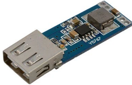
Εικόνα 13. Μετατροπέας σταθερής τάσης ρεύματος
