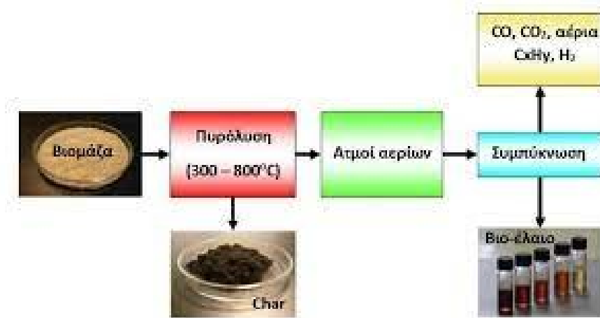
Σχήμα 3.7 Στάδια πυρόλυσης προς ενέργεια. Πηγή σχήματος: ruas.gr
