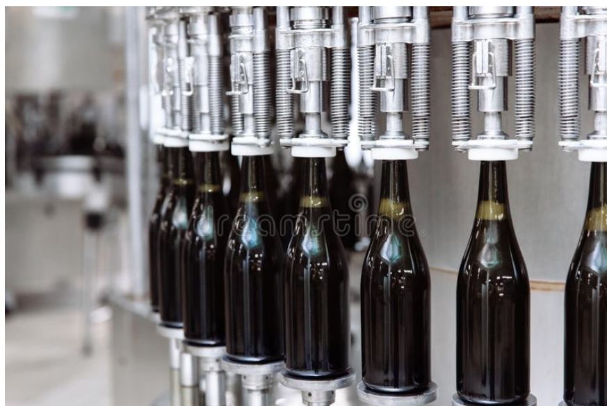
Σχήμα 2.17. Εμφιάλωση μπουκαλιών στην αυτόματη γραμμή. Πηγή σχήματος: lcinternational.it
