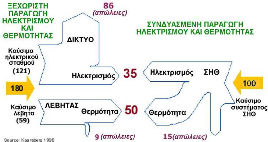
Σχήμα 17. Συμβατικό ενεργειακό σύστημα σε σύγκριση με σύστημα συμπαραγωγής [10]
