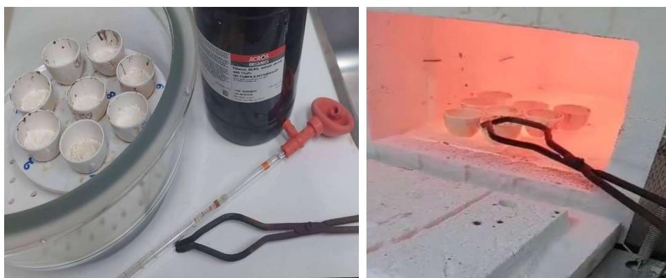
Εικόνα 12 & 13 : Στην πρώτη εικόνα βλέπουμε προλογισμένες κάψες πορσελάνης και προσθήκη αιθανόλης με ειδική πιπέτα - πουαρ. Στην δεύτερη εικόνα βλέπουμε την τοποθέτηση των καψών στον ειδικό φούρνο.[27]
