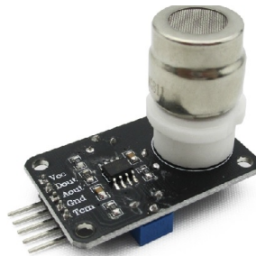
Εικόνα 13. Αισθητήρας διοξειδίου του άνθρακα MG811 [37]
