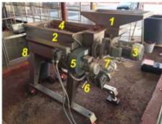
Εικόνα 4. Φυγοκεντρικός διαχωριστής (Tamborrinoa A. et al., 2019)
