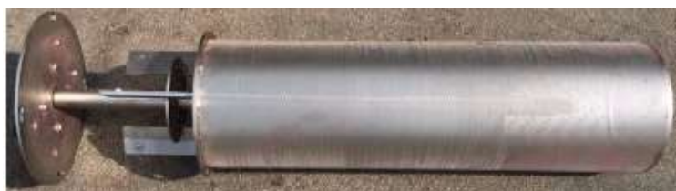
Εικόνα 5. Διάτρητος κύλινδρος και μπουμπίνα με λεπίδες (Tamborrinoa A. et al., 2019)
