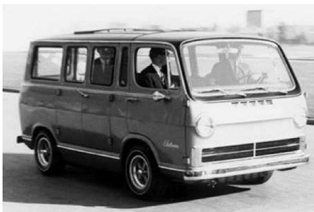
ΕΙΚΟΝΑ 16: GM ELECTROVAN ΜΕ ΚΥΨΕΛΗ ΚΑΥΣΙΜΟΥ UNION CARBIDE (ΠΗΓΗ: ΤΑΝÇ ET AL., 2019).
