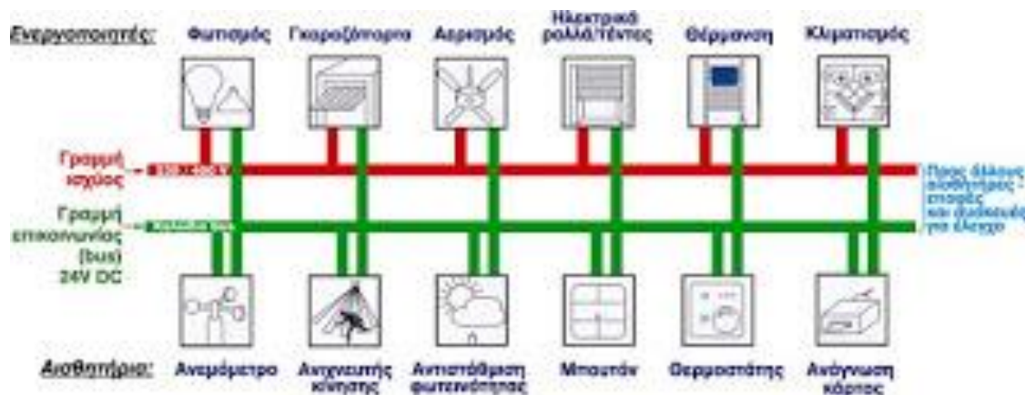
Εικόνα 2.3: Ηλεκτρολογική εγκατάσταση με KNX
