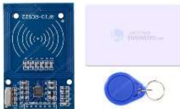
Εικόνα 41: Σύστημα αναγνώρισης ραδιοσυχνοτήτων RFID
