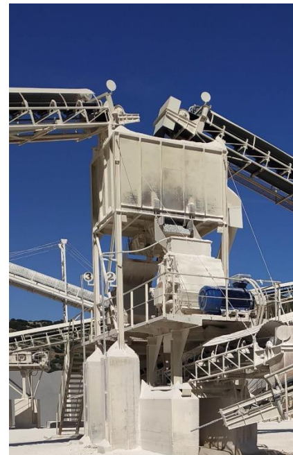
Εικόνα 2: 3 ο στάδιο θραύσης βλέπουμε τον σπαστήρα Νο 2 και στο πίσω μέρος τον σπαστήρα Νο 3
