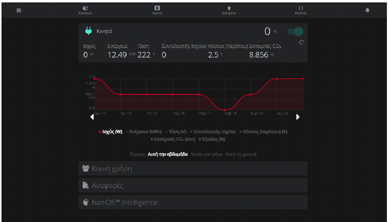
Σχήμα 2.5: Menu του ρευματοδότη που τροφοδοτεί κινητό με το γράφημα της ισχύος του για μια εβδομάδα
