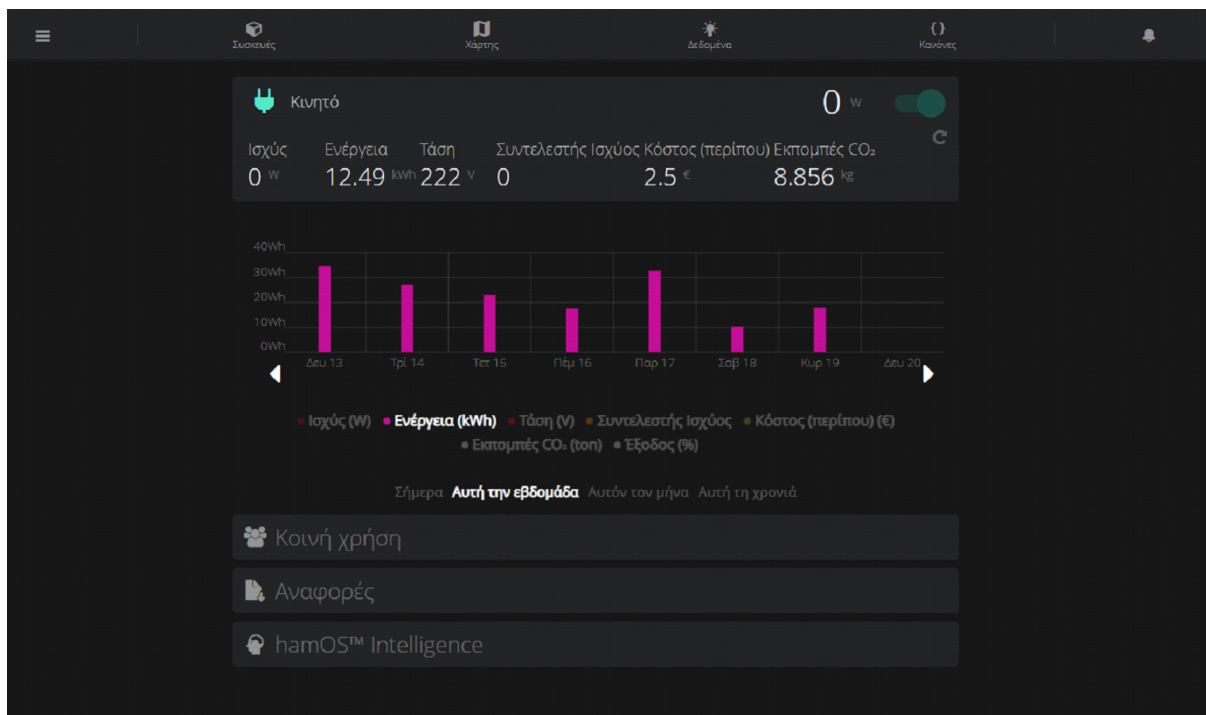
Σχήμα 2.6: Menu του ρευματοδότη που τροφοδοτεί κινητό με το γράφημα της ενέργειας του για μια εβδομάδα.
