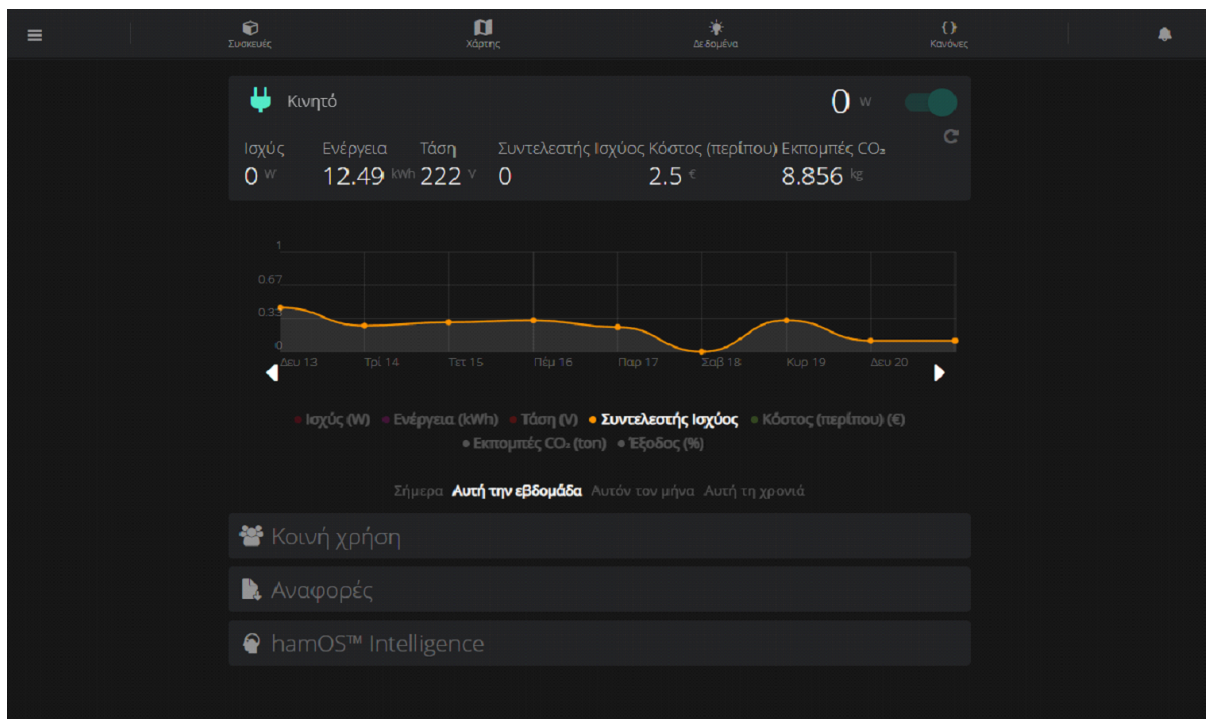
Σχήμα 2.7: Menu του ρευματοδότη που τροφοδοτεί κινητό με το γράφημα της ενέργειας του για μια εβδομάδα.
