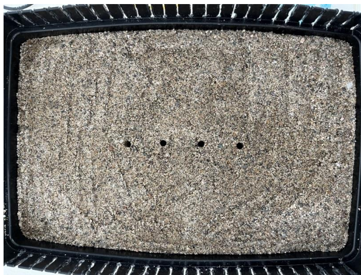
Εικόνα 4.13: Οπές μετά την μέτρηση αφού έχουν αφαιρεθεί οι οδηγοί για να συμπιεστεί το έδαφος
