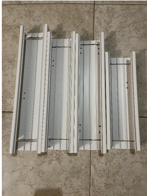
Εικόνα 3.11: Ηλεκτρολογικό κανάλι κομμένο σε τέσσερα κομμάτια (ένα για κάθε δοχείο της Εικόνας 3.1)
