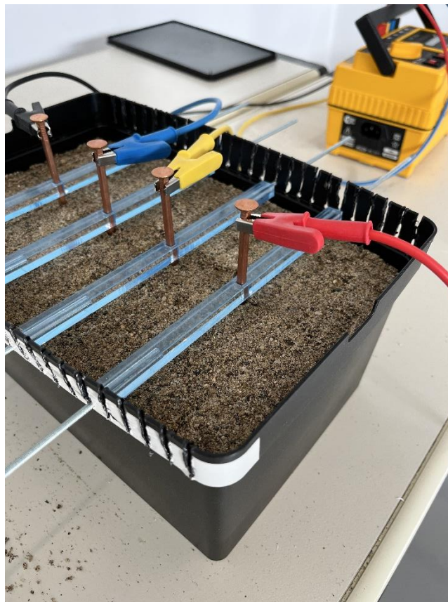
Εικόνα 4.11: Μέτρηση με χάλκινα ηλεκτρόδια σε απόσταση 5 cm
