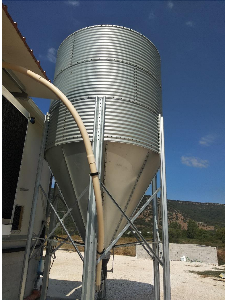
ΕΙΚ. 6: Σιλός: Τοποθετείται η τροφή των πτηνών και στη συνέχεια διανέμεται
