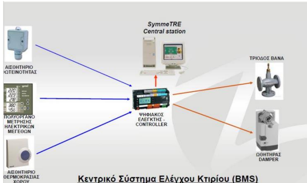
Εικόνα 4: Βασική δομή BMS συστήματος
