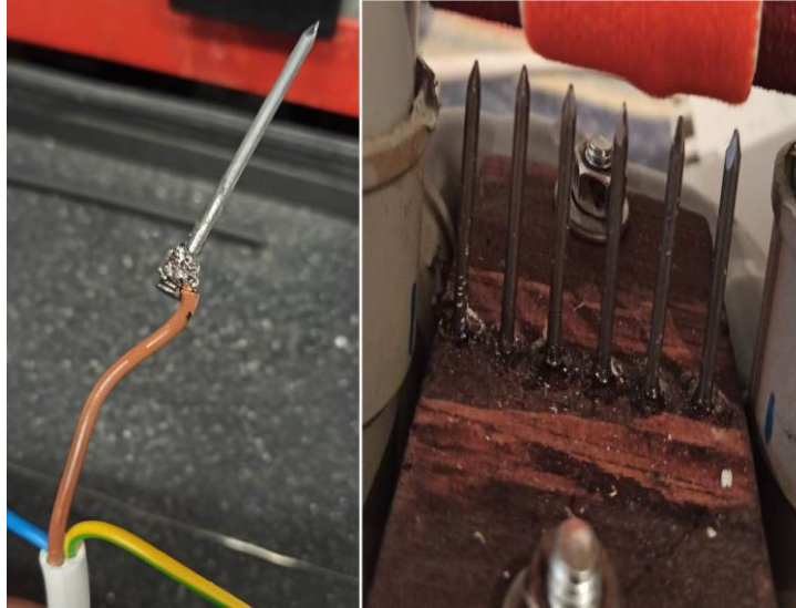
Εικόνα 3.5 Στιγμιότυπο κατασκευής V – Κάτω χτένα και τοποθέτησή της
