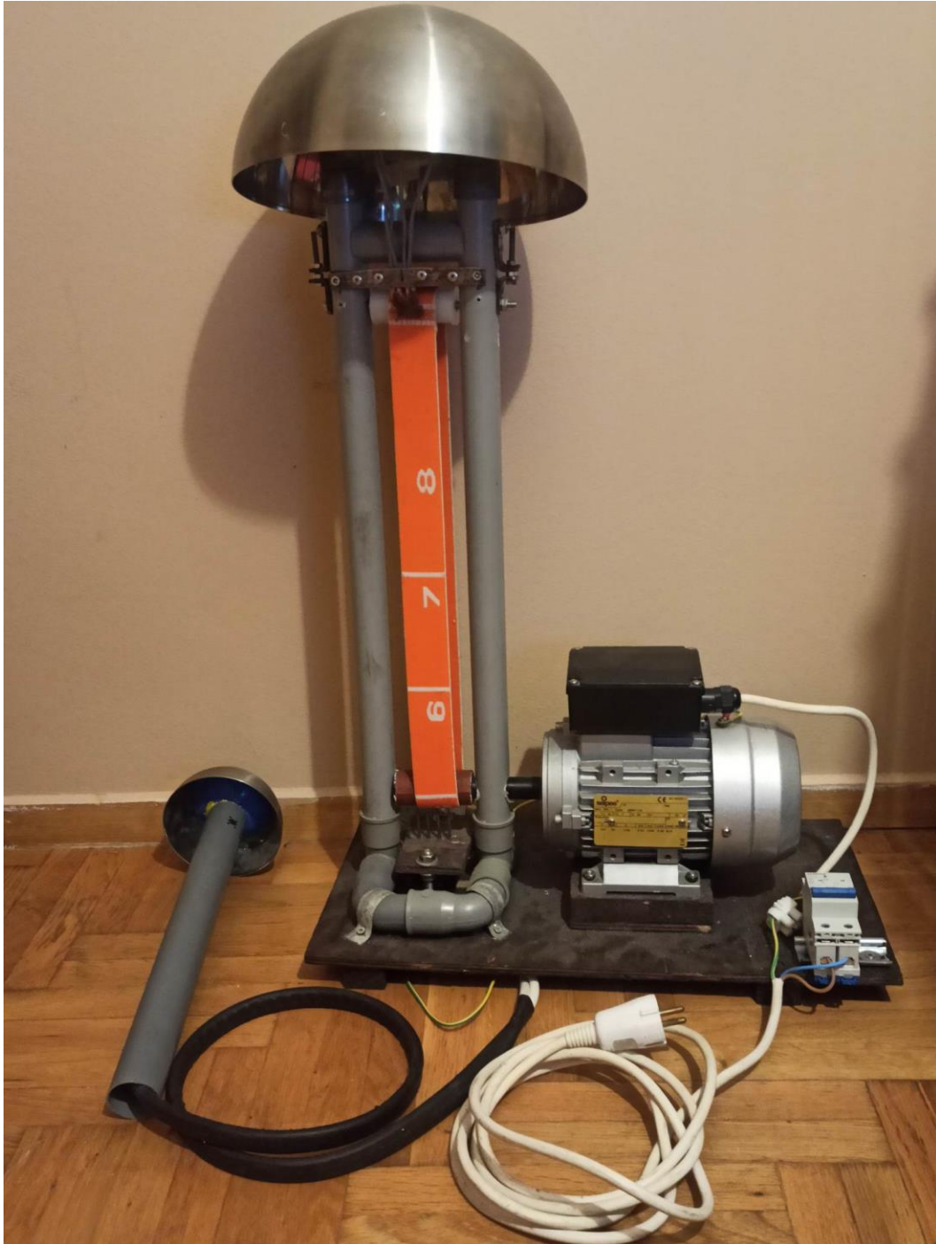
Εικόνα 3.10 Γεννήτρια Van de Graaff που κατασκευάστηκε στα πλαίσια της πτυχιακής εργασίας
