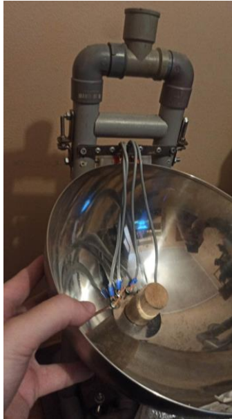
Εικόνα 3.7 Στιγμιότυπο κατασκευής VII – Εσωτερικό ημισφαιρικού ηλεκτροδίου
