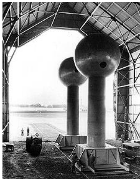
Εικόνα 1.2 Η ηλεκτροστατική γεννήτρια των 7 MV [2]
