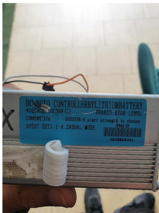
ΕΙΚΟΝΑ 21: Ο ΕΓΚΕΦΑΛΟΣ (CONTROLLER)
