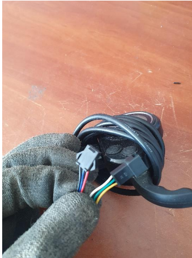
ΕΙΚΟΝΑ 19: ΤΑ 3 ΚΑΛΩΔΙΑ ΤΟΥ ΑΙΣΘΗΤΗΡΑ ΓΚΑΖΙΟΥ ΚΑΙ 3 ΚΑΛΩΔΙΑ ΤΡΟΦΟΔΟΣΙΑΣ
