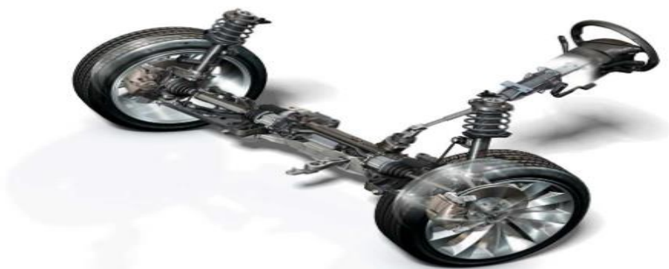
εικόνα 3. 6 Μηχανισμός διεύθυνσης ηλεκτρικού οχήματος
